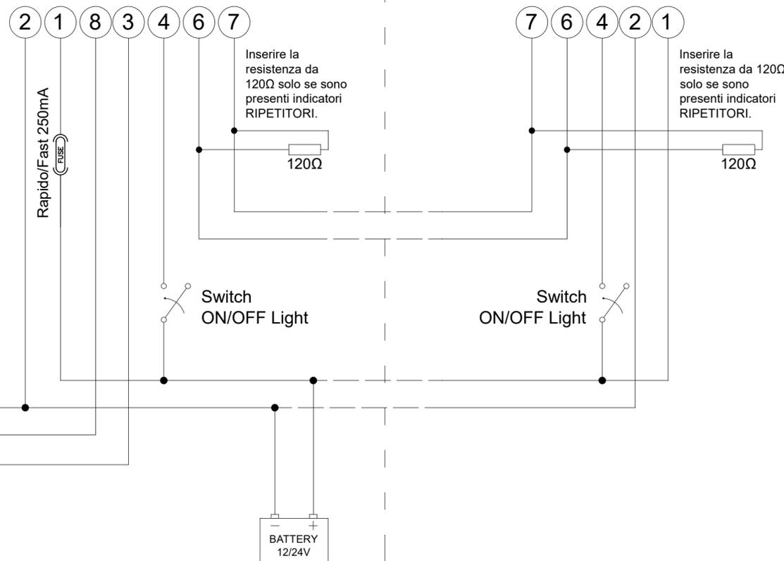
**Pinout strumento Ø100mm**
